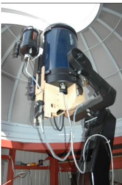
図-2: 塩川の観測所、主鏡は Meade 製 35cm シュミットカセグレン望遠鏡、CCD は SBIG 製 ST-9E、測光は Rc バンドで行った
